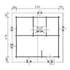
Parois robustes rainurées languettées en sapin du nord de 45 ou 60mm d'épaisseur.
