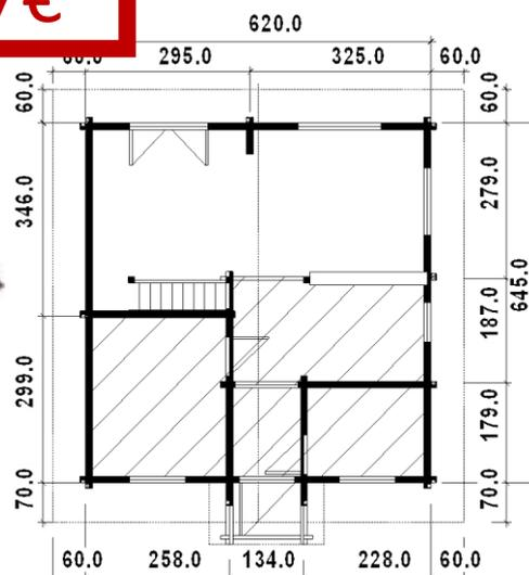
Parois robustes rainurées languettées en sapin du nord de 60 ou 95mm d'épaisseur.
